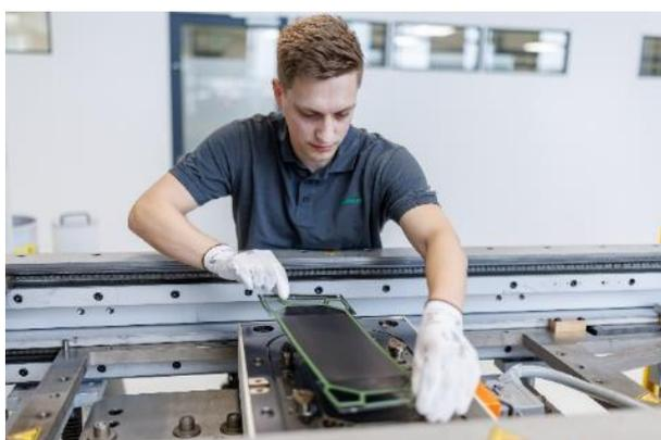
À Herzogenaurach, Schaeffler produit des plaques bipolaires pour des prototypes et petites séries de constructeurs automobiles internationaux, jusqu'à plusieurs dizaines de milliers d'unités. La ligne de fabrication pilote fait partie du centre de compétence pour l'hydrogène de l'entreprise, qui comprend également de nombreux bancs d'essai et installations de test.
